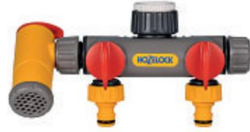
Der Verteiler wird einfach auf den Wasserhahn aufgeschraubt. An den Verteiler können nun zwei Gartenschläuche oder Zuläufe für Bewässerungssysteme angebracht werden. Ein dritter Auslauf (drehbar bis zu 90°) ermöglicht jederzeit ohne lästiges Abtrennen der Schläuche die Entnahme von Wasser z.B. Eimer, Gießkanne etc. Alle drei Anschlüsse sind individuell an- und ausstellbar. Verteiler für 1/2" und 3/4" Anschlüsse.
