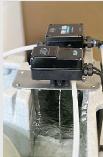
Schwerkraftversion mit automatischer Wehrplatte
