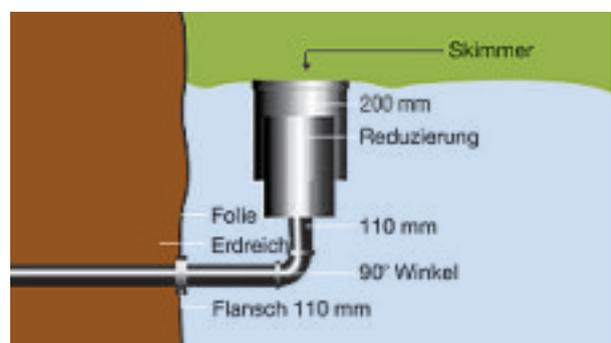
Beispiel für den fachgerechten Anschluss eines schwimmenden Skimmers.
