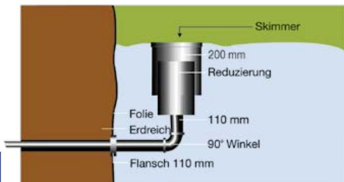
Beispiel für den fachgerechten Anschluss eines schwimmenden Skimmers.
