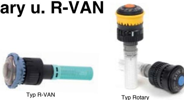
Beim **Typ Rotary** verteilen die mehrstrahligen Düsen das Wasser gleichmäßig von 0 - 360° über die gesamte Wurfweite, welche per Strahlstörsschraube verkürzt werden kann.
