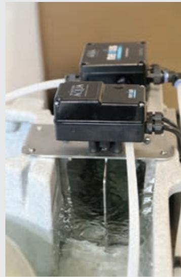
Schwerkraftversion mit automatischer Wehrplatte
