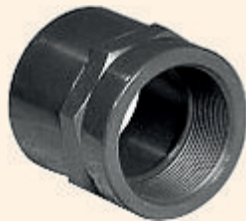
Übergangsmuffe Klebemuffe x Innengewinde 16 Bar
