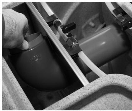
Abbildung 17.2 90° Drehung zum Bypass
