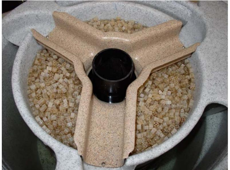
6. Luftpumpe einschalten und das Luftventil am EazyPod öffnen. Nach einigen Sekunden bewegen sich die K1-Medien und zirkulieren, so dass die Selbstreinigung durchgeführt wird.
